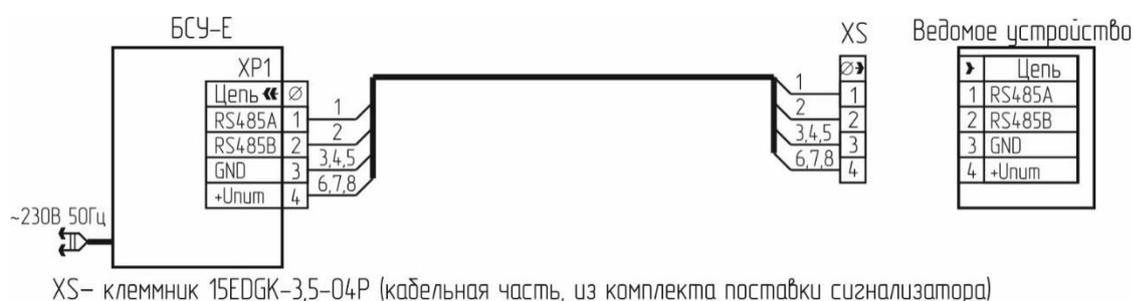
Рисунок А.1 – Схема соединений для программирования адресов.
